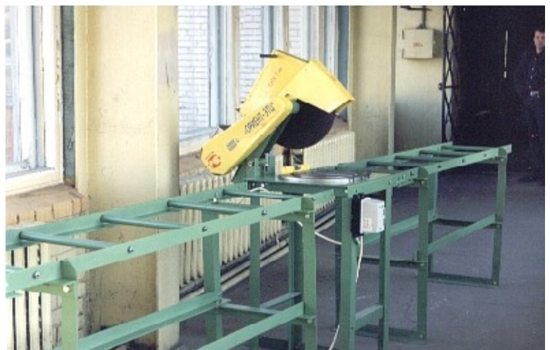
Станок ДОС-400ТП2 в напольном исполнении с рольгангами.
