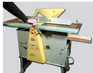
ПСР-1 – рейсмусование с механической подачей материала
